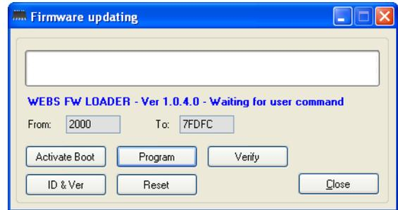
Il pulsante **“ID & Ver”** permette di visualizzare la versione corrente del firmware caricato nel modulo WEBS.
