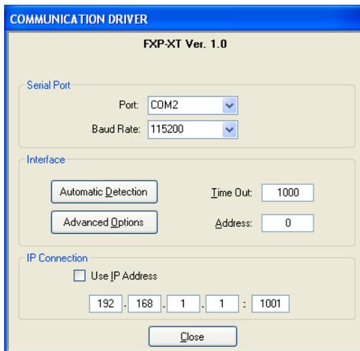
In alternativa si può utilizzare una connessione Ethernet specificando l'indirizzo IP del convertitore collegato alla porta seriale di MCP-XT; questo convertitore NON può essere lo stesso WEBS in modalità bridge.
