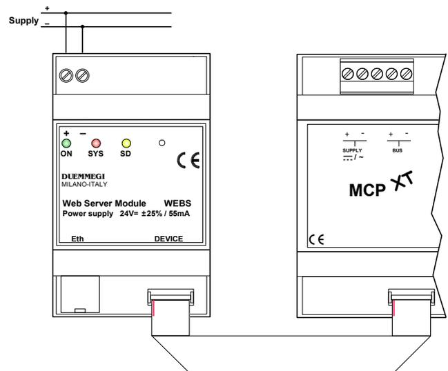
Come si può vedere è necessario collegare il modulo WEBS ad una tensione di alimentazione in corrente continua tra 9 e 24V. È necessario connettere inoltre il modulo alla rete Ethernet ed al controllore del sistema **CONTATTO** MCP XT mediante l'apposito cavo piatto; in questo modo il modulo WEBS diventa pienamente operativo.
