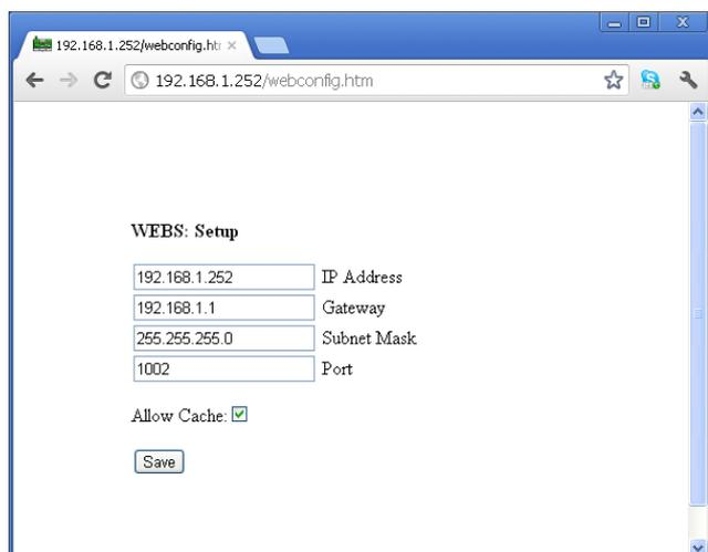
In questa pagina di configurazione sarà possibile impostare i parametri voluti per Indirizzo IP, Gateway, Maschera Sottorete, e la Porta Bridge. I valori visualizzati nella precedente figura sono quelli di default. La finestra di configurazione consente di utilizzare anche la cache del browser, opzione che consente di velocizzare i tempi di risposta del modulo stesso.
